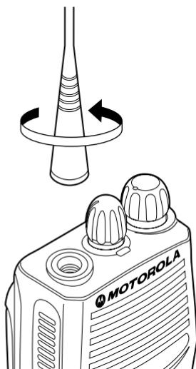
Для отсоединения антенны поверните ее против часовой стрелки.
