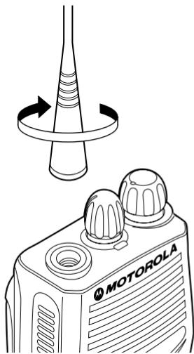
Для присоединения антенны поверните ее по часовой стрелке до фиксации.
